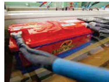
Batterierne gennemgår en stor del af testen i et vandbad ved konstant 25 °C.
